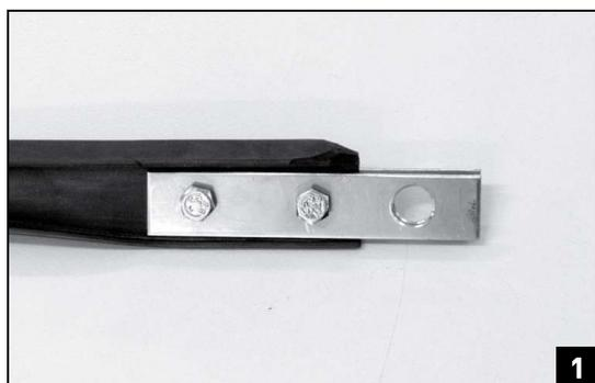
Для установки герметизирующей ленты применяется монтажное устройство. Обе герметизирующие ленты при этом протягиваются одновременно. Перед монтажом необходимо подготовить и положить обе герметизирующие ленты с одного конца шинопровода.
