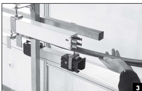
Ввести монтажную тележку с герметизирующей лентой в шинопровод. При этом необходимо следить за тем, чтобы оба профиля герметизирующей ленты были правильно введены в установочные желоба в нижней части шинопровода.
