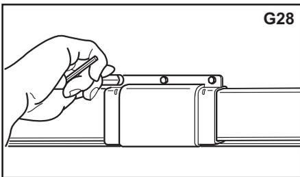
**Соединения контактных рельсов и корпуса (для KSG)**
