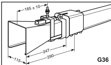
Смонтируйте шинопровод с растробом таким образом, чтобы на протяжении 2-3 м они понижались относительно оси на 5-10 мм, для того чтобы токосъемник въезжал по верхнему скосу раструба. На участке шинопровода, предшествующем растробу, токосъемник должен передвигаться таким образом, чтобы рессора пружинного захвата прижималась к поверхности скольжения шинопровода с небольшим усилием (**S3**).
